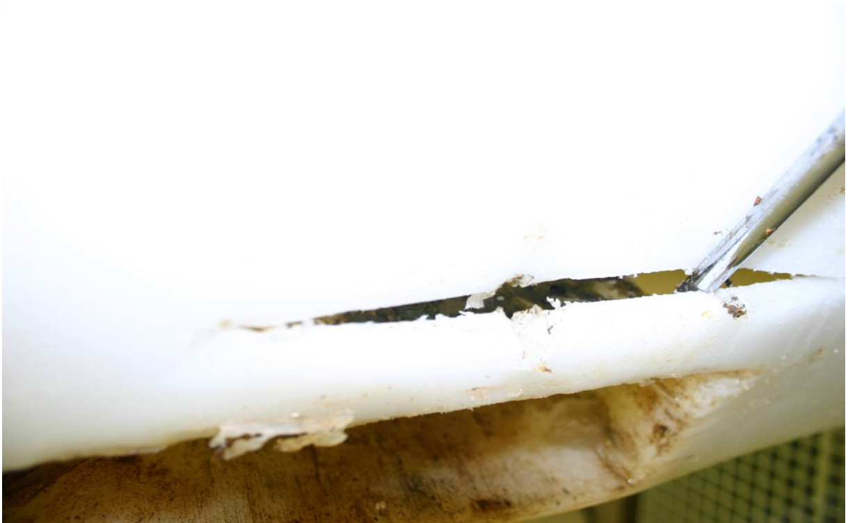
Bilde 2 Bildet viser en smal, lang skade i nedre del av containerveggen. Legg merke til sorte felter med skitt inni containerkroppen
